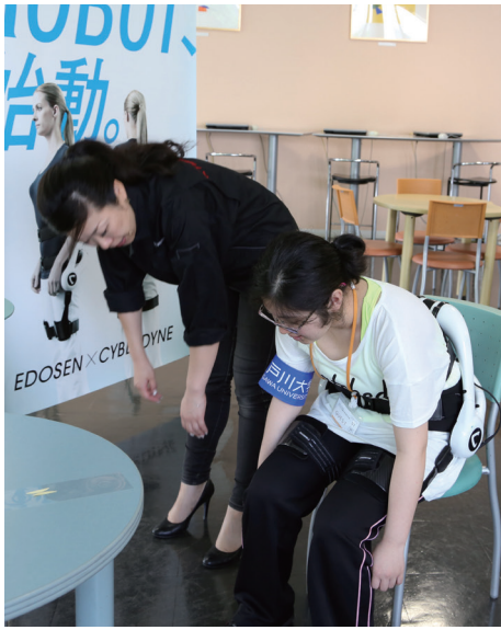
HAL®は人が体を動かすときに脳から筋肉へ送られる信号を読み取って、自分が動きたいようにサポートしてくれる。
